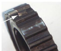
Износ узкого зуба в виде скола, потертости. Замена обязательна!!!!
